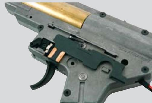
Vamos a instalar un nuevo selector, que como podéis ver si que incorpora la placa de contacto. En ocasiones, cuando el sistema de disparo no lo necesita, es recomendable retirarla para prevenir cortocircuitos. Éste selector, aún funcionando en automático es el que vamos a modificar.
